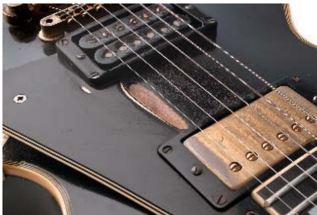
Vom Stromschlag verbranntes Holz und Plastik.
